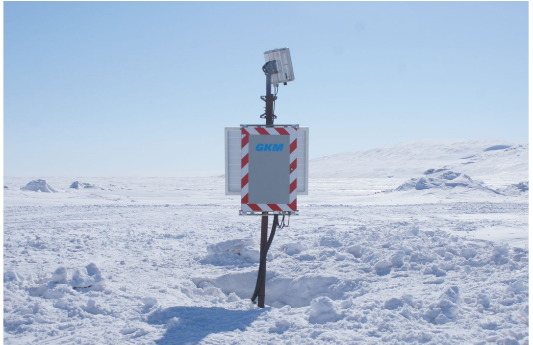
Système d'acquisition série DL avec télémetrie par antenne satellite
