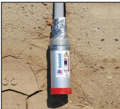
1. Préparez le géophone en sondage en enroulant les raccordements avec du ruban électrique pour qu'ils restent propres.
