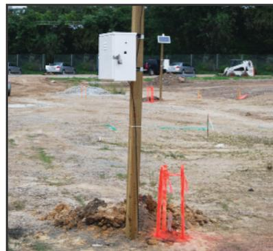
6. Emplacement du géophone en sondage clairement marqué et moniteur placé dans un boîtier bien fermé.
