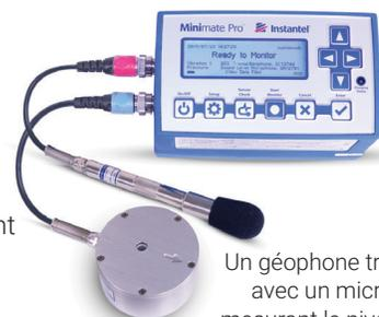
Un géophone triaxial ISEE avec un microphone mesurant le niveau sonore ou un microphone linéaire
