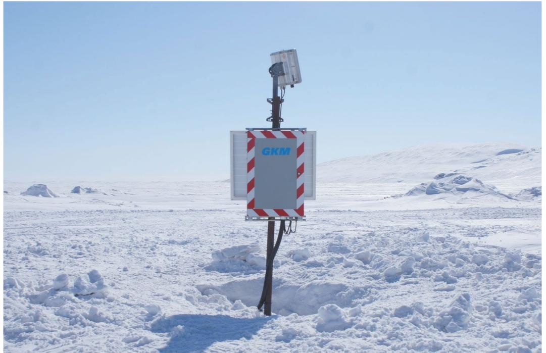
Système d'acquisition série DL avec télémétrie par antenne satellite
