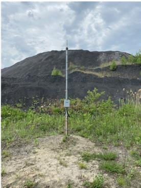
Conversion du relevé manuel du niveau d'eau en une acquisition de données automatisée
