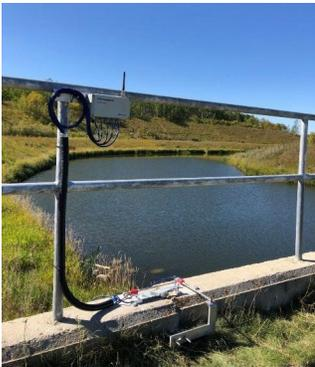
Suivi des fissures sur le mur du déversoir
