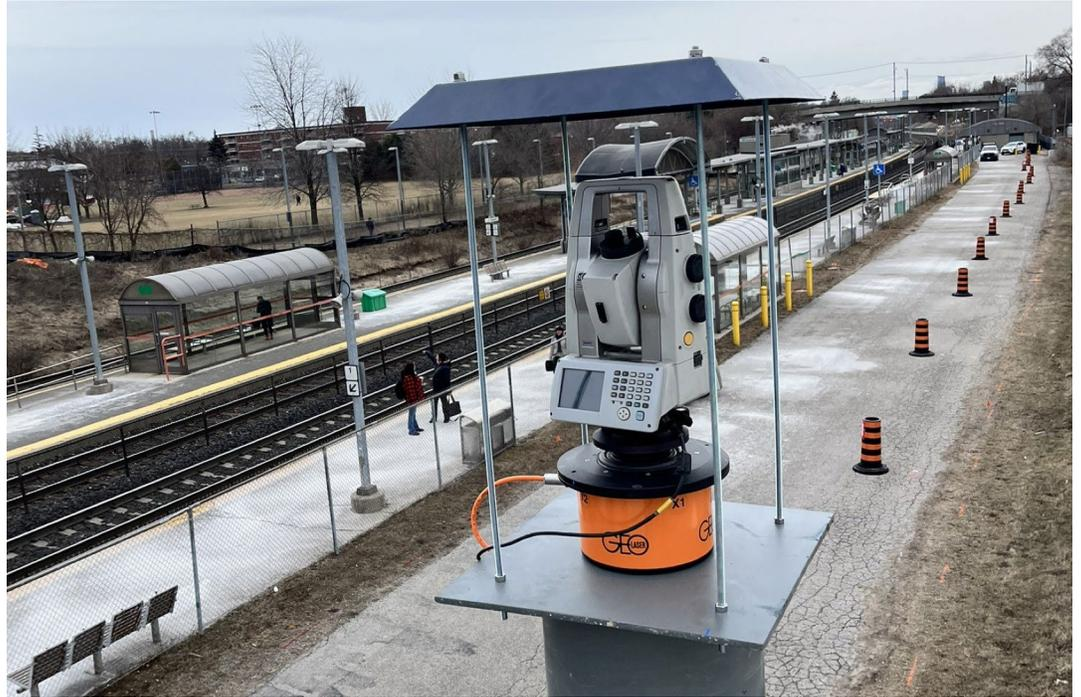
AMTS sur tribrach à nivellement automatique
