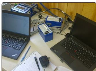
♦ Séismographes et système d'acquisition de données pour la surveillance à distance des vibrations et des fissures
