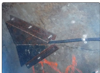
♦ Protection robuste des fissuromètres contre les dommages potentiels de débris effluents
