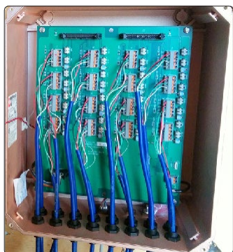
◆ Système d'acquisition pour instruments à corde vibrante alimenté par batterie
