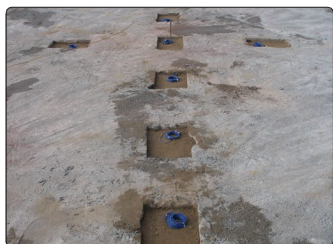
♦ Cellules de pression totale en fondation
