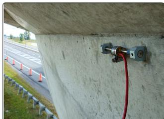
◆ Jauge de déformation à corde vibrante
