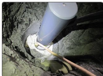
◆ Mesure de déformation des dépôts meubles avec des extensomètres
